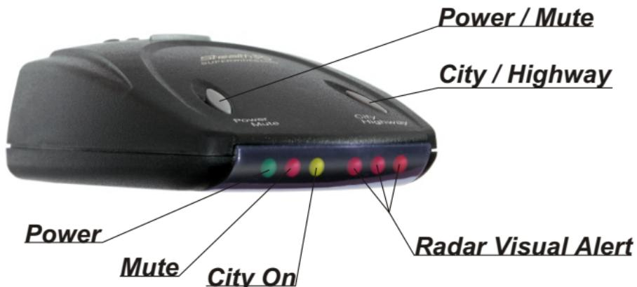
Переключение режимов работы прибора осуществляется коротким нажатием кнопки **City/Highway**. В режиме City (Город - горит желтый индикатор **City**) прибор обеспечивает максимальную помехозащищенность, а в режиме Highway (Трасса - желтый индикатор выключен) максимальную дальность. При пользовании прибором следует учитывать, что в режиме Highway помехоустойчивость прибора снижается и в зоне сильных радиопомех возможны ложные сигналы тревоги.
