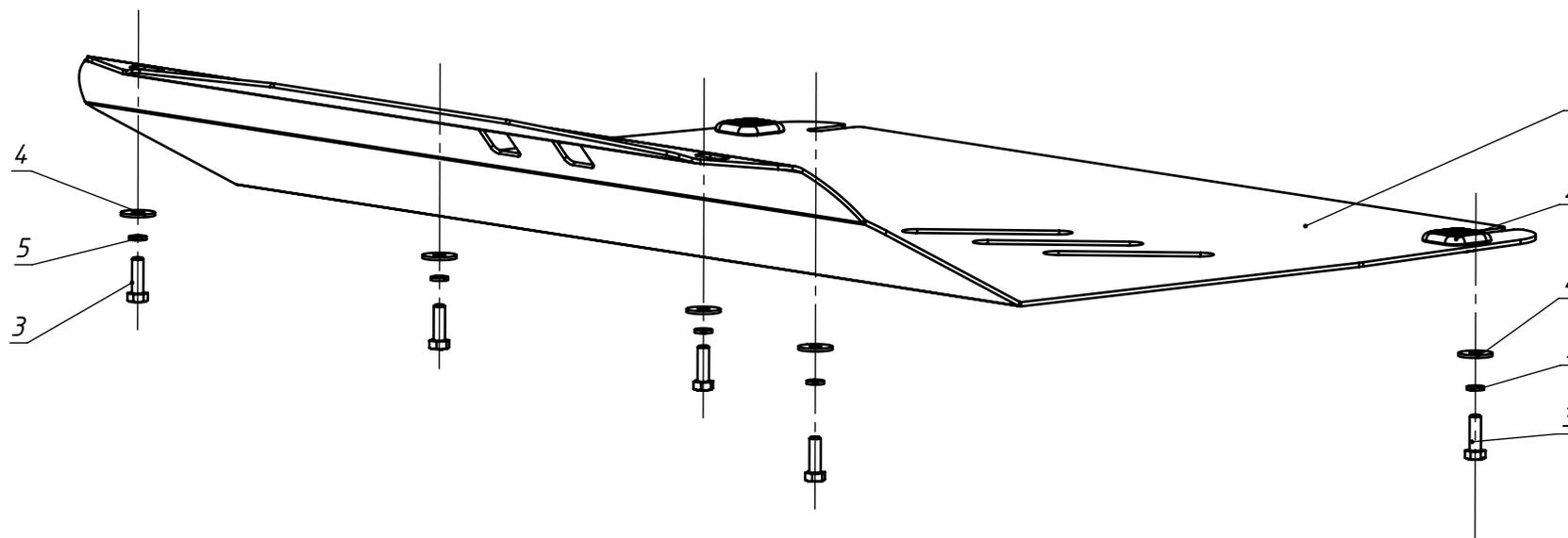
1. Выкрутить штатные болты М8, крепящие пыльник к балке радиатора.
